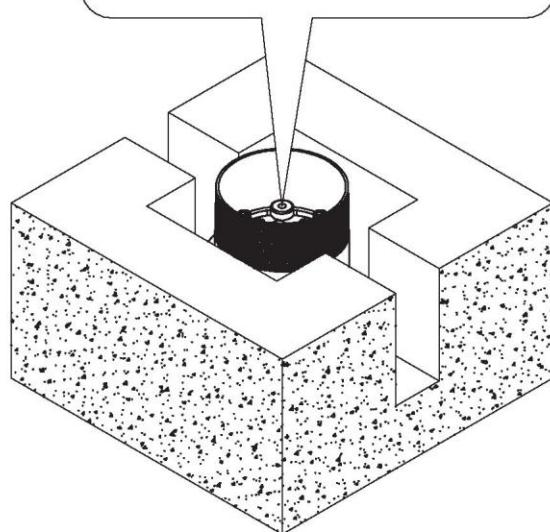
**5.** Installieren Sie das Ventil mit der Kassette unter Verwendung der Befestigungsschrauben und überprüfen Sie dann erneut die Höhe des Ventilkörpers und stellen Sie es ein.
