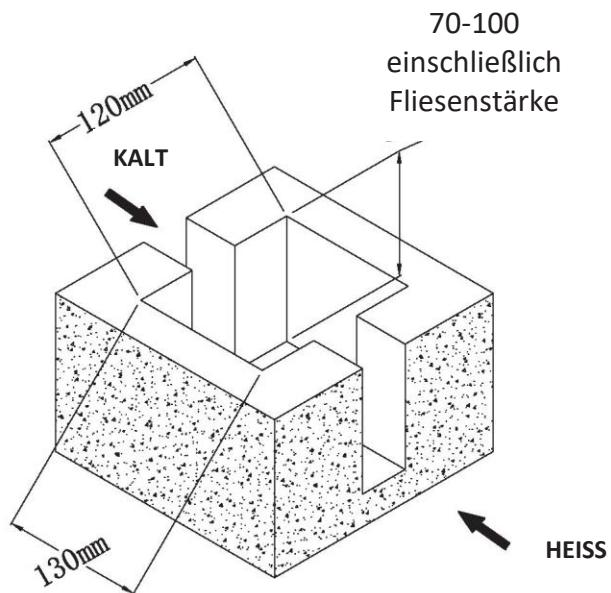
**2.** Reinigen Sie die Warm- und Kaltwassereinlässe vollständig und schließen Sie die Einlässe dann an das Ventil an.
