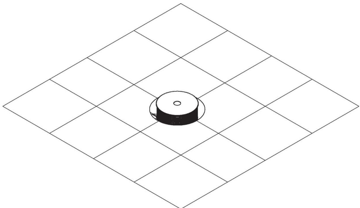
**7.** Dichten Sie die Verbindung zwischen dem Sockel und der Fliese mit Silikon ab, um zu verhindern, dass Wasser unter die Oberfläche eindringt.
