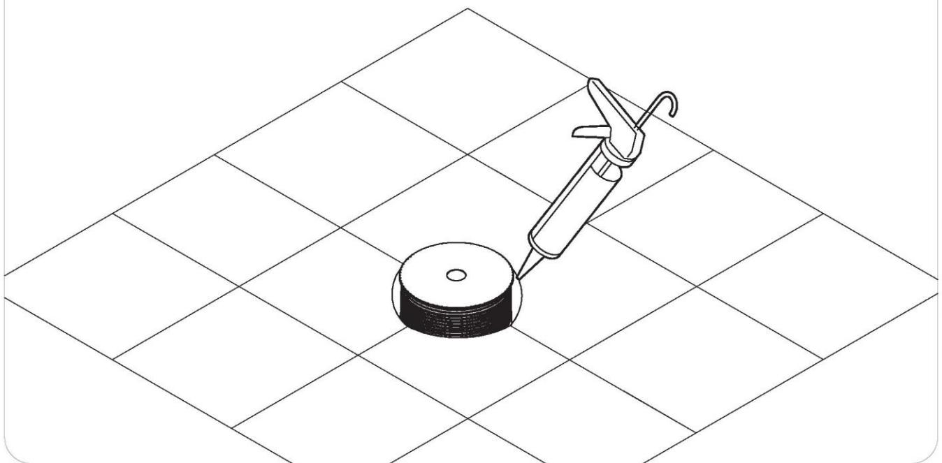
**8.** Schneiden Sie den überstehenden Teil der Kassette aus und achten Sie darauf, dass der Boden auf gleicher Höhe mit den Fliesen liegt.
