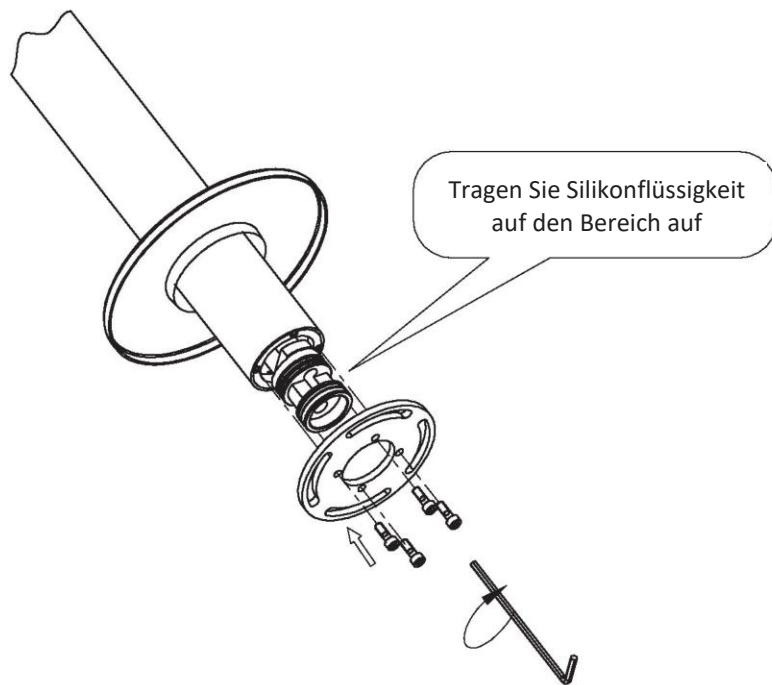
**11.** Montieren Sie den Batteriekörper (Rohr) mit einer Unterlegscheibe und M5-Schrauben im Sockel. Stellen Sie sicher, dass die Schrauben fest angezogen sind.
