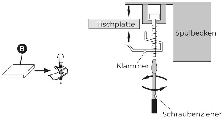
**3.** Tragen Sie Silikon auf. Füllen Sie die Spüle zur Hälfte mit Wasser, um sie gegen die Tischplatte zu drücken, während das Silikon trocknet.
