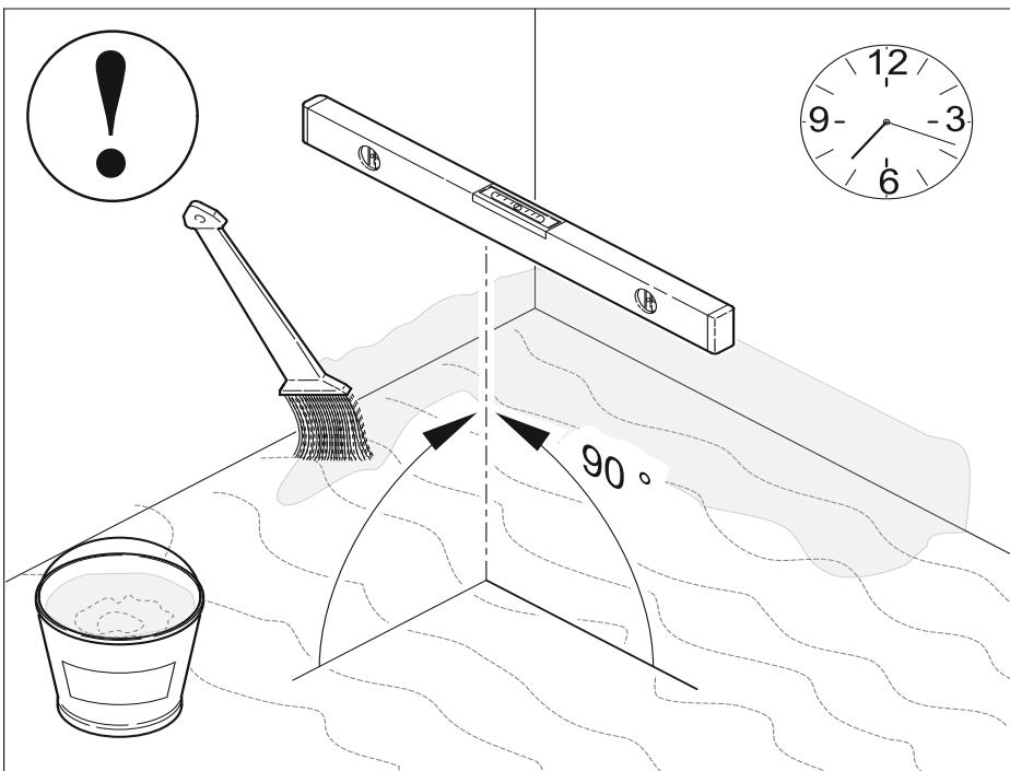
**PL** UWAGA! Powierzchnia montażowa powinna być czysta, równa, stabilna bez widocznych spękań. Cały łazienkę, a w szczególności miejsce montażu wannы należy odpowiednio uszczelnić np. przy użyciu folii uszczelniającej w płynie. Zapobiegnie to zalaniu niższej kondygnacji w przypadku złego montażu płytek lub awarii syfonu.
